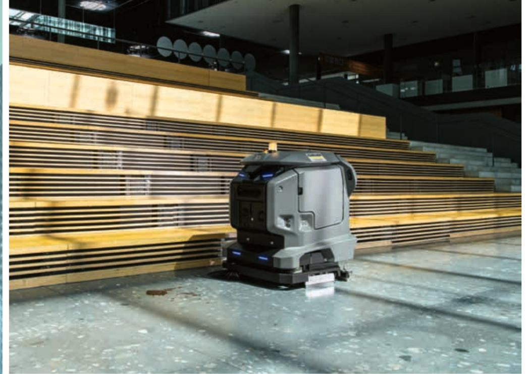
Dank leistungsstarker 160-Ah-Lithium-Ionen-Batterie, Walzenbürstentechnik mit Vorkehrfunktion, Seitenbesen und 55 Zentimeter Arbeitsbreite ist die Reinigungsleistung von KIRA B 50 uneingeschränkt mit der einer konventionellen Scheuersaugmaschine vergleichbar.
